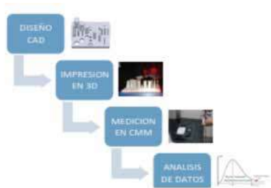
Figura 2: Metodología de prueba de excentricidad
