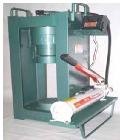
Figura 1. Máquina de ensayos utilizada en el ensayo de aptitud CNM-EA-720-0008/2018.
