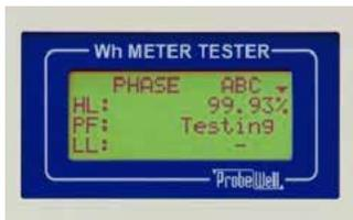
El período de medición de energía termina automáticamente después de los 3 puntos de prueba (HL, PF y LL).
