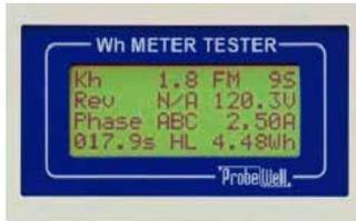
Mientras el equipo está probando, se pueden verificar los resultados parciales de la prueba presionando la tecla Mode. Presione Mode otra vez para regresar al menú de prueba.
