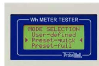
Presione Mode otra vez para regresar al menú de prueba. Presione Start/Stop para iniciar la prueba. La corriente de la carga se incrementara hasta llegar a HL (2.5A) en las 3 fases simultáneamente (ABC). El medidor empezará a enviar pulsos y el patrón interno de energía iniciará a
