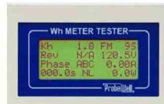
El Kh y la Forma del medidor son mostradas en la pantalla de controlador. La tensión es aplicada al medidor pero sin carga (NL). Mas detalles son mencionados en la Guía del usuario.
