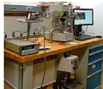
Figura 4. Sistema completo del nuevo patrón nacional para bajas presiones, FPG8601.
