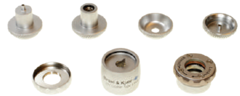
(d) Acoplador de 2 cm 3 . Ayudas auditivas. IEC60318-5.
