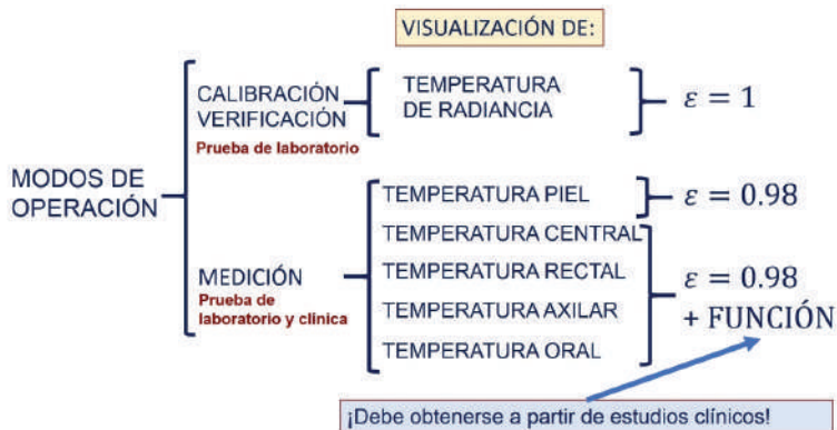
Figura 6. Tipos de termómetros IR clínicos y sus modos de operación.
