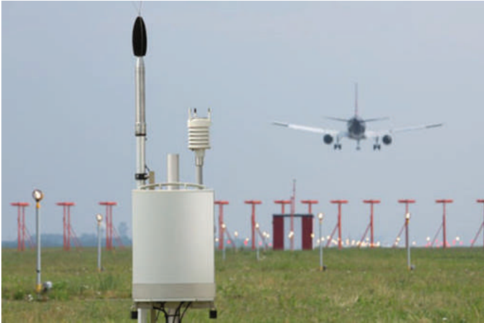
Fig. 8. Estación de monitoreo continuo de ruido en el perímetro de un aeropuerto.
