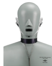
Fig. 3. Diferentes simuladores y acopladores, conforme a IEC60318, empleados en la calibración de transductores de equipo para medición de la respuesta humana al ruido; de la marca Hottinger Brüel & Kjær.
